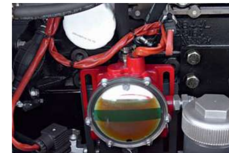
Dispositivo di rabbocco automatico olio Automatic lube oil refuelling system Dispositif de remplissage automatique de l'huile
