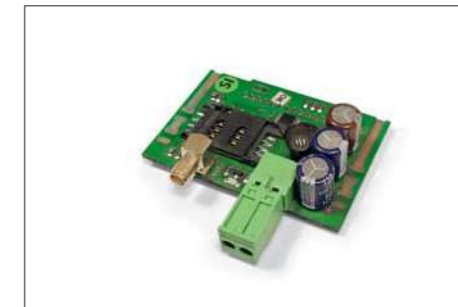
IL-NT-GPRS Modem GSM e internet GPRS (solo per COMAP) IL-NT-GPRS GSM modem and internet GPRS (only for COMAP) IL-NT-GPRS modem GSM et internet GPRS (seulement pour COMAP)
