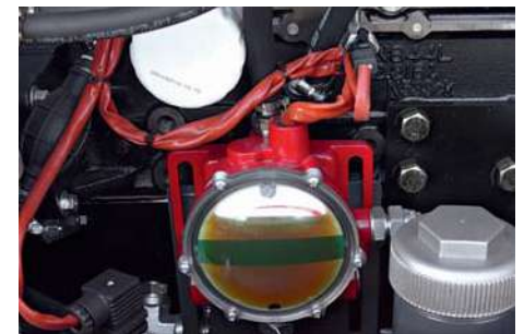
Dispositivo di rabbocco automatico olio Automatic lube oil refuelling system Dispositif de remplissage automatique de l'huile
