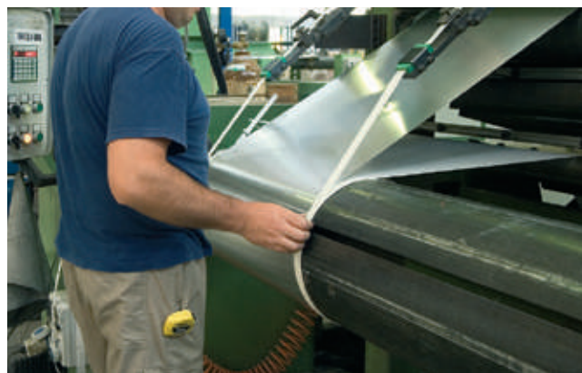
Изготовление обмотки низкого напряжения
